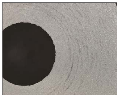
Kąt przystawienia 6° – Rz 11.3 µm
